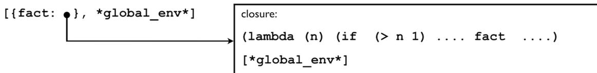
図 3.1 [:fact 1] 評価時の環境のようす。λ式評価時の環境に fact がいないため、クローージャ内の環境には fact は存在せず、[:fact 1] でクローージャ中の fact を参照しようとするエラーになる。
